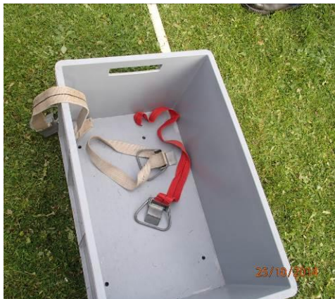
špatně (kovová část venku)
